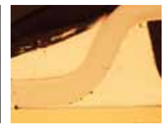
납땀부 Crack 분석
